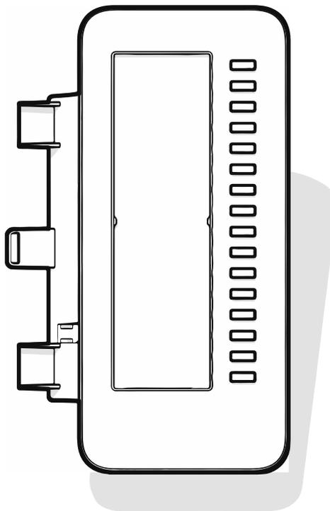
Le KM410 est un module d'extension optionnel à fixer et connecter au côté droit du téléphone. Il fournit 16 touches de fonction programmables supplémentaires sur deux niveaux avec voyants (voir "[Touches de fonction programmables](#)" → page 62).
